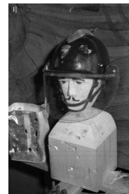
1| Juin 1968, test de résistance d'un casque avec visière transparente à différents projectiles (boulons et vis).
